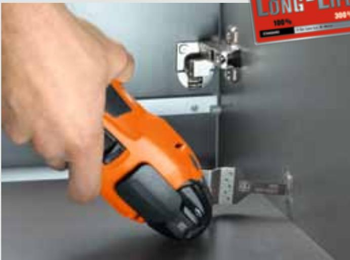
Die schmalen FEIN E-Cut Long-Life-Sägeblätter verfügen über eine für Holzwerkstoffe optimierte BiMetall-Verzahnung mit Schränkung. Sie sind nagelfest und sehr robust bei Berührung mit Mauerwerk und anderen harten Materialien. Durch die relativ deutliche Schränkung arbeiten die Sägeblätter auch bei hohen Schnitttiefen in harte Materialien wie z. B. massives Buchenholz perfekt.
