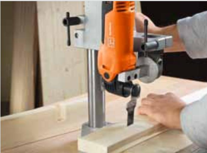
Ein handelsüblicher Bohrständer und die FEIN Tisch- und Bohrständerhalterung machen aus dem FEIN MULTIMASTER eine stationäre Werkzeugmaschine für den universellen Einsatz in der Werkstatt oder vor Ort.
