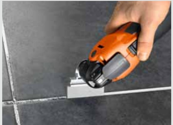
Mit dem FEIN Fliesenfugen-Reiniger lassen sich stark verschmutzte Fliesenfugen schnell und einfach ohne Beschädigung der Fliesen reinigen. Die Fugen sehen danach wieder wie neu aus, auch bei extremen Verschmutzungen. Mit seiner hohen Standzeit ist dies eine besonders wirtschaftliche Alternative zur kompletten Neuverfugung. Ideal für Schwimmbäder, Hoteleinrichtungen ebenso wie für Bäder und Küchen in Privathaushalten.
