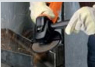
Entfernen Sie problemlos und rückstandsfrei Grate an den Kanten grob bearbeiteter Werkstücke.
