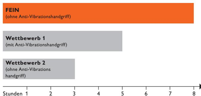
Durch verschiedene konstruktive Maßnahmen erreichen die FEIN Compact-Winkelschleifer auch ohne Anti-Vibrationshandgriff extrem niedrige Vibrationswerte zwischen 2,5 und 5  $m/s^2$ . Aufgrund dieser Vibrationswerte ist das Arbeiten mit FEIN Compact-Winkelschleifern bis zu acht Stunden möglich. Durch weitere Maßnahmen wie z.B. den FEIN Anti-Vibrationshandgriff können die Vibrationswerte noch einmal um 40% reduziert werden.
