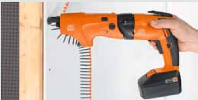
Die FEIN Trockenbauschrauber absolvieren mehr als 1 Million Verschraubungen – und das ohne jegliche Wartung. Das entspricht bei 25 Schrauben pro Quadratmeter einer Fläche von über 40 000 Quadratmetern.
