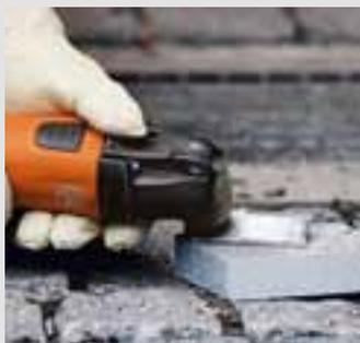
Der Reinigungsblock wird zum Nachschärfen und Putzen des Diamantwerkzeugs benutzt. Dichtstoffreste und andere Verunreinigungen werden schnell und leicht entfernt.
