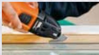
Mit spezieller Zubehör-Ausstattung perfekt geeignet für die schnelle, einfache und saubere Sanierung kittverlegter Isolierglasscheiben und für den Altfenster-Austausch. Mit bis zu 80% Zeitersparnis.
