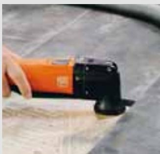
Mit der Hartmetall-Raspel lassen sich auf einfache und schnelle Weise Reste von Putz oder Estrich abtragen oder Fliesenkleber vor der Neuverfliesung plan schleifen.
