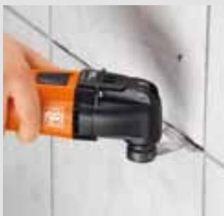
Das 2,2 mm breite, diamantbeschichtete Segmentmesser schneidet Marmor-, Epoxydharz- und Trassfugen. Die Fliesen können anschließend zer schlagen und entfernt werden.
