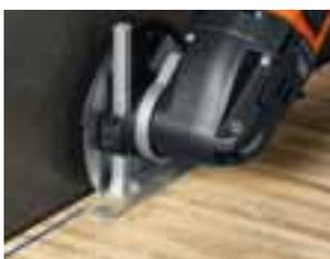
Dank der patentierten, mechanischen Schnittstelle kann der FEIN SUPERCUT zum Beispiel auch mit einem Tiefenanschlag eingesetzt werden.
