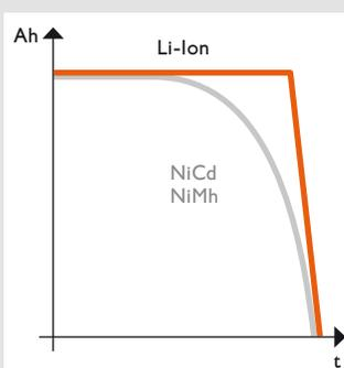
Stark vom ersten bis zum letzten Schnitt: Die neue FEIN Lithium-Ionen-Technologie sorgt für konstante Leistung bis zur vollständigen Entladung der Akkus.
