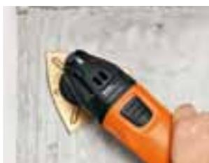
Die neue große Hartmetall-Raspel bietet hohen Arbeitsfortschritt und eignet sich hervorragend zum Planschleifen von Spachtelmasse, Fliesenkleber, Beton, Zement und Stein. Sie ist auch mit Staubabsaugung einsetzbar.
