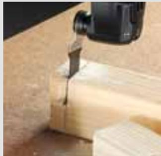
Die langen E-CUT Long-Life-Sägeblätter sind die Alternative zum Stemmeisen. Damit lassen sich Konstruktionshölzer bis ca. 80 mm vor Ort bearbeiten.
