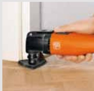
Der FEIN SUPERCUT CONSTRUCTION ist auch als hochwertiger Dreieck-Schleifer, z. B. als Ergänzung zur Parkett-Schleifmaschine, insbesondere an engen Stellen, einsetzbar.
