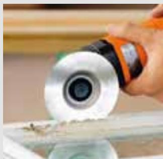
Der FEIN SUPERCUT ist die Alternative zu Druckluft-Meißel und Kittfräse, z.B. zum Entkitten von Einfach- und Verbundverglasungen vor Ort – praktisch ohne Glasbruchgefahr und ohne aufwendige Vorarbeiten.
