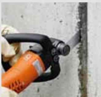
Alle elastischen Fugendichtstoffe schneiden Sie mit dem universell einsetzbaren, geraden Schneidmesser heraus. Ideal für Großobjekte: Der im Profi-Set enthaltene, kraftsparende Handgriff.
