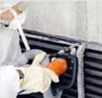
Mit dem FEIN SUPERCUT ist ein weitgehend staubfreies Austrennen des Fugenmaterials bei montierter Absaugvorrichtung garantiert.
