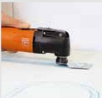
Mit dem FEIN Aussparwerkzeug wird der Kanal für eine Warmwasser-Fußbodenheizung direkt in die Bauplatte geschnitten.
