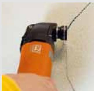
Mit dem geraden Schneidmesser lassen sich Bauplatten schnell und einfach zuschneiden. Dabei sind sowohl gerade Schnitte als auch alle wichtigen Radien möglich.
