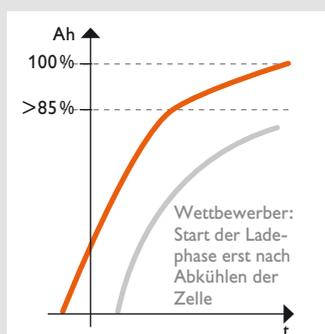
Verkürzte Ladezeit: Aufgrund hochwertiger Akkuzellen mit geringem Innenwiderstand wird die Erwärmung reduziert und der Akku muss bei Außentemperaturen bis 45°C nicht gekühlt werden.
