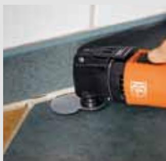
Schadhafte, elastische Silikon- oder Acryl-Anschlussfugen werden mit dem Schneidmesser in Pilzform schnell und rückstandsfrei entfernt. Neue Fugematerialien können ohne Nacharbeit aufgebracht werden.
