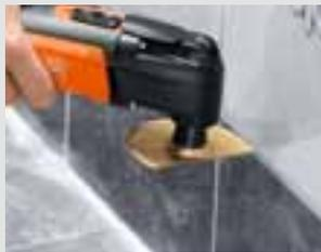
Diamant- und Hartmetall-Segmentsägeblätter mit einem Durchmesser von 90 mm lassen sich problemlos einsetzen. Mit maximalem Hub für besten Arbeitsfortschritt.
