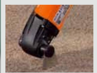
Mit dem Segmentmesser oder dem Spachtel lassen sich alte Teppich-, PVC- oder Linoleum-Bodenbeläge in handliche Streifen schneiden.
