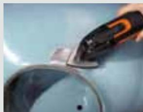
Lackfehler und Fehlstellen schnell und sauber beheben: die Dreiecks-Schleifplatte garantiert hohe Abtragsleistung und ein gleichmäßiges Schleifbild.
