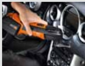
M-Cut-Sägeblätter für kurze präzise Schnitte an schwer zugänglichen Stellen. Universell einsetzbar für Kunststoffe oder Karosserieblech ab 10 mm Kantenlänge.
