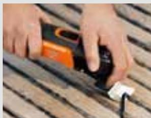
Überstände nach dem Verfugen mit dem festen Spachtel schnell und präzise zurückschneiden. Das vereinfacht das anschließende Abschleifen des Teakdecks.
