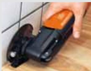
Einsatz als „Mini-Kreissäge“ – das HSS-Sägeblatt Holz ist ideal für lange, präzise Schnitte, z. B. bei Dehnfugen in Parkett und Laminat. Mit oder ohne Tiefenanschlag einsetzbar.
