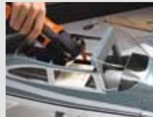
Aussparungen ab 10 mm Breite mit dem schmalen M-CUT Sägeblatt. Passgenau ausfeilen und entgraten mit der Hartmetall-Feile. Für Holz, Kunststoffe, GFK, CFK, Metall und mehr.
