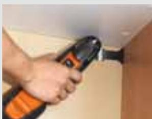
Mit dem E-CUT Universal-Sägeblatt Ausschnitte für Kabelzugänge, Steckdosen und Wasseranschlüsse sägen – ohne aufwendige Demontage.
