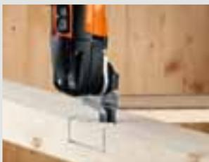
Das E-CUT Universal-Sägeblatt mit 60 mm Schnitttiefe ermöglicht schnelles, sauberes Zuschneiden von Konstruktionshölzern und ist auch mit Tiefenanschlag einsetzbar.
