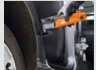
Abschnittsreparaturen werden mit den stabilen, runden HSS-Sägeblättern schnell erledigt. Da sie sich mehrfach auf der Antriebswelle verdrehen lassen, erhöht sich ihre Standzeit.
