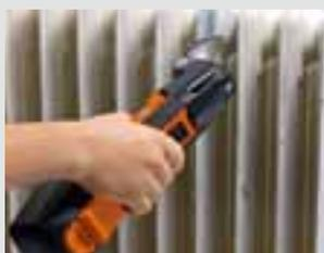
Schwer zugängliche Stellen sind mit dem langen, schmalen Schleiffinger optimal zu bearbeiten.
