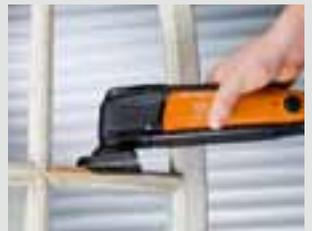
Für blitzsaubere Ergebnisse: staubfreies Arbeiten mit Absaugung. Einsetzbar mit dem runden Schleifteller, der gelochten Dreiecks-Schleifplatte und der HM-Raspel.
