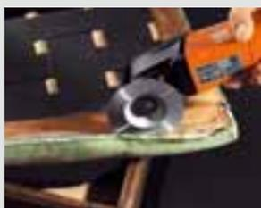
Das gekröpfte HSS-Sägeblatt schont Ihre Kräfte und die Polster – denn Verklammerungen lassen sich leicht trennen und müssen nicht mit einer Zange herausgerissen werden.
