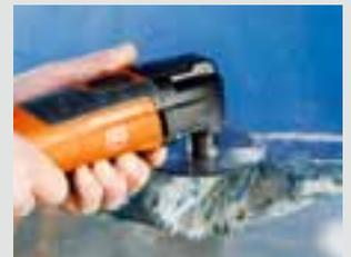
Perfekte, saubere Schnitte an GFK- oder CFK-Bootsrümpfen ohne Ausrisse oder Beschädigungen am Laminat mit HSS-Sägeblättern.
