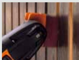
Mit den auswechselbaren Einsätzen des Profil-Schleif-Sets gelingt das Schleifen an engen Stellen, in Nuten und an Profilen bequem und mit deutlich höherer Abtragsleistung.
