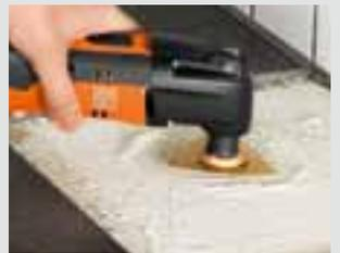
Die Hartmetall-Raspel ist das Allround-Zubehör beim Fliesenlegen: zum Glätten von Fliesenkleber, Schleifen von Fliesenrändern und für die Herstellung eines planen Untergrundes.
