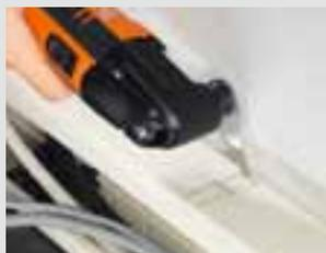
Mit dem schmalen M-CUT-Sägeblatt sind Ausschnitte schon ab 10 mm Kantenlänge kein Problem. So lassen sich z. B. Elektro-Installationen sauber durchführen.
