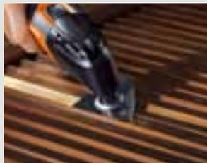
Die flache Schleifplatte kommt auch in enge Zwischenräume, z. B. bei Fensterladen-Lamellen.
