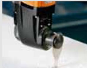
Sägen mit höchster Präzision, ab 10 mm Kantenlänge in Holz, Kunststoff, GFK oder Blech: Auch kleinste Aussparungen gelingen einfach und schnell mit dem M-CUT-Sägeblatt.
