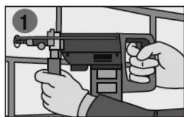
Mit Schlagbohrmaschine Loch bohren. Bohrlochdurchmesser und Ankerstange müssen in jedem Fall übereinstimmen.
