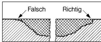
Die mit diesem Verfahren erzielte Mindestschichtdicke im Randbereich verbessert die Stabilität des Reparaturmörtels. Folgeschäden durch Kornzertrümmerung oder durch Ablösung in auslaufenden Randzonen werden verhindert.
