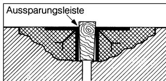
Die Kanten von Fugen  $\geq 10$  mm müssen durch Winkeleisen gesichert werden.
