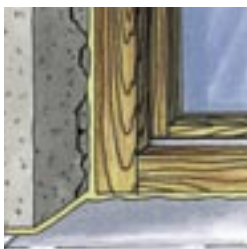
Bei geringem Spannungsabbau Abrissgefahr am Putz
