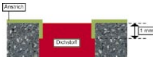
Bereits vorhandener Anstrich mit nachfolgender Fugenabdichtung
