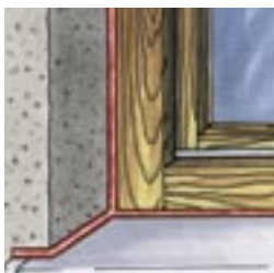
Intakte Fuge mit Polyurethan
