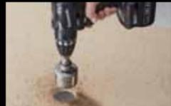
Bohren vertikal in Platten
