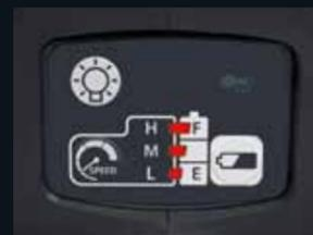
Wählbare Hammereinschlagstärke entsprechend der Materialhärte
