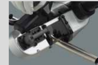
Bandgeschwindigkeit 1 (langsam) Für rostfreien Stahl usw.*2
