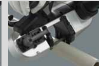
Bandgeschwindigkeit 2 (mittel) Für Ablaufrohre von Klimaanlage usw.*2
