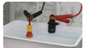
(Bild) Eingang 10.000VAC für 3 Minuten mit isoliertem Handgriff und Eintauchen in Wasserbecken.
