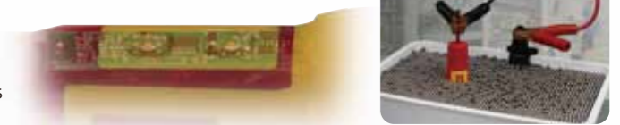
(Bild) Eingang 10.000VAC für 3 Minuten durch Eintauchen in Metallkugelbecken.
