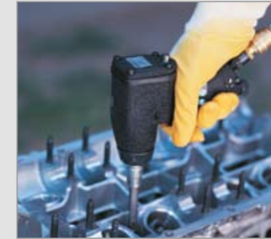
Schlagschrauben bei Reparaturarbeiten
