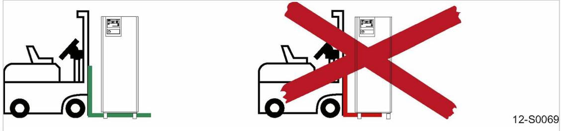
Abb. 42 Mit Gabelstapler transportieren
