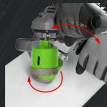
TIPP: Durch taumelnde Arbeitsweise optimale Stauzufuhr sowie hoher Bohrfortschritt. Passend für Winkelschleifer
