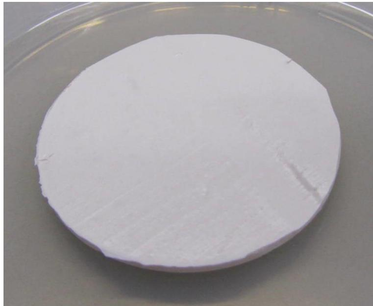
Foto 1: Untersuchungsmaterial **Bostik 2720 MS, Farbe weiß** nach einer Inkubationszeit von 28 Tagen ohne sichtbaren Pilzbewuchs
