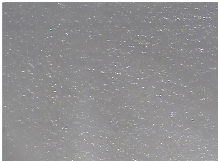
Foto 2: Untersuchungsmaterial **Bostik 2720 MS, Farbe weiß** (50fach vergrößert) nach einer Inkubationszeit von 28 Tagen ohne sichtbaren Pilzbewuchs
