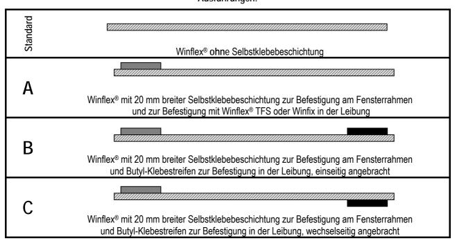
Bei Verwendung der Ausführungen mit Butyl-Kautschuk-Klebestreifen ist bei Folienbreiten über 150 mm eine zusätzliche mechanische Befestigung oder zusätzliches Ankleben mit Winflex® TFS oder Winfix notwendig (Fassadenbereich).
