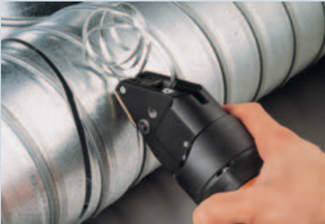
Schneiden von Wickelfalzrohren
