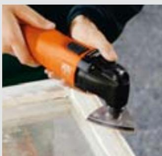
Das Schleif-Set ermöglicht dank hoher Abtragsleistungen müheloses Entfernen von alten Anstrichen – ohne große Staubentwicklung.
