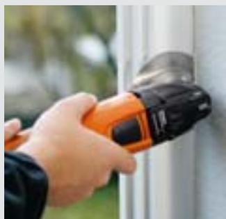
Mit dem HSS-Sägeblatt ist ein Altfenster-Ausbau auch in sensiblen Fällen möglich. Wandbeschädigungen werden vermieden, das Sägeblatt liegt plan auf dem Rahmen auf. Metall-Befestigungen werden problemlos durchtrennt.
