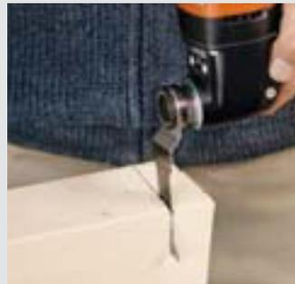
Die langen E-CUT Standard-Sägeblätter sind die Alternative zum Stemmeisen. Damit lassen sich Konstruktionshölzer bis ca. 80 mm vor Ort bearbeiten.
