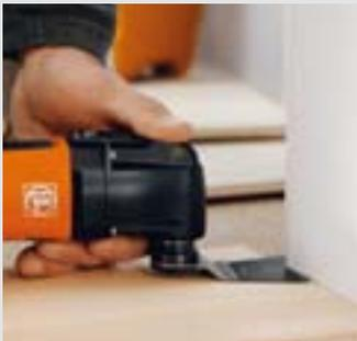
Türstöcke kürzen gelingt perfekt. Durch die Abkröpfung wird plan zur Fläche gesägt.
