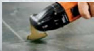
Diamant- und hartmetallbeschichtete Werkzeuge zum Austrennen von Fugenzement-Materialien und zum Zurückschleifen von Fliesenkleber.
