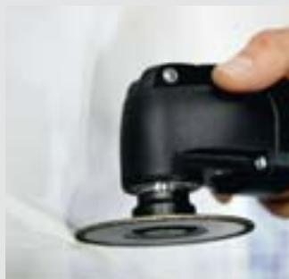
Für Dauereinsätze gibt es Diamant- oder Hartmetallsägeblätter auch in runder Ausführung. Diese 360°-beschichteten Werkzeuge lassen sich 3–4 mal verdrehen und erreichen so eine deutlich höhere Lebensdauer als segmentierte Messer.
