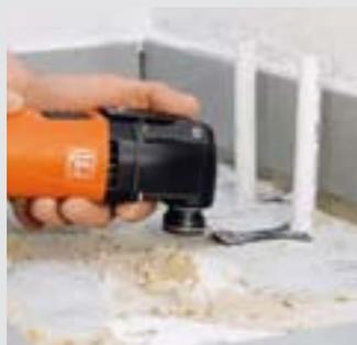
Nicht mehr benötigte Kupfer-Heizungsrohre lassen sich mit den gekröpften E-CUT Univer-sal-Sägeblättern auch an schwer zugänglichen Stellen plan zu Wand oder Boden absägen.
