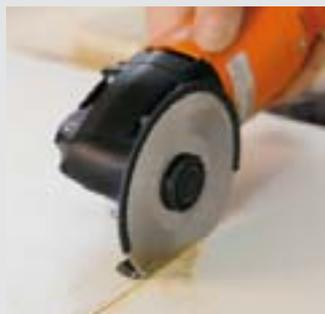
Mit dem HSS-Sägeblatt Holz können auch längere, gerade Schnitte durchgeführt werden. Rolladenkästen-Abdeckungen und ähnliche Teile können so vor Ort jederzeit präzise neu angefertigt oder angepasst werden.
