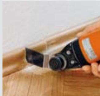
Der FEIN SUPERCUT CONSTRUCTION benötigt keine Freiräume hinter dem Werkstück. Nachträgliche Aussparungen, z. B. in montierten Sockelleisten, lassen sich schnell und sauber herstellen.
