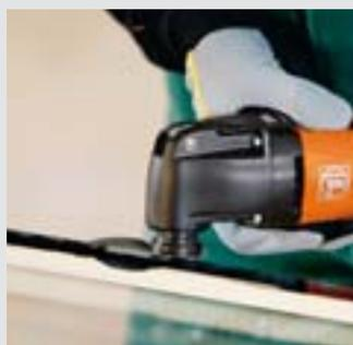
Das pilzförmige Schneidmesser trennt Isolierglasscheiben mühelos und schnell. Unbeschädigte Einzelscheiben lassen sich für weitere Reparaturen nutzen. Die Material-Trennung für die Entsorgung ist extrem einfach.
