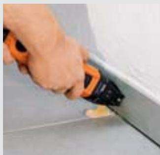
Für besonders schmal ausgeführ-te Fliesenfugen ist zusätzlich zum 2,2 mm breiten diament-beschichteten Segmentmesser ein extra dünnes, nur 1,2 mm breites Segmentmesser in Hart-metall-Ausführung enthalten.
