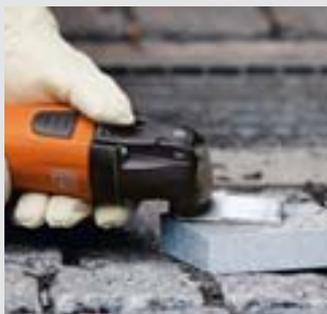
Der Reinigungsblock wird zum Nachschärfen und Putzen des Diamantwerkzeugs benutzt. Dichtstoffreste und andere Verunreinigungen werden schnell und problemlos entfernt.
