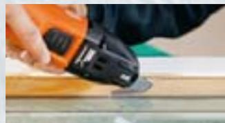
Perfekt für die schnelle, einfache und saubere Sanierung kittbettverlegter Isolierglasscheiben und für den Altfenster-Austausch. Bis zu 80 % Zeitersparnis!
