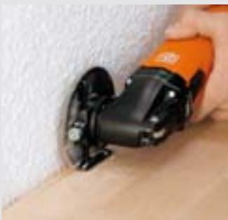
Das HSS-Sägeblatt Holz eignet sich hervorragend zum randnahen Sägen, z. B. bei Parkett- oder Laminatböden. Kaminöfen können so problemlos nachträglich montiert, Wand- oder Deckenverkleidungen bearbeitet werden.
