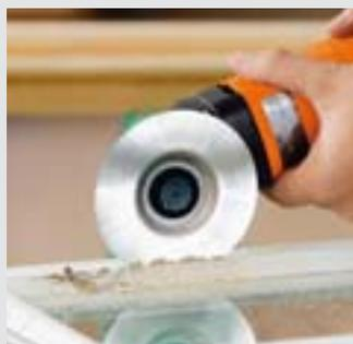
Der FEIN SUPERCUT ist die Alternative zu Druckluft-Meißel und Kittfräse. Z. B. zum Entkiten von Einfach- und Verbundverglasungen vor Ort – ohne Glasbruchgefahr, ohne aufwändige Vorarbeiten und ohne die Fenster auszuhängen.
