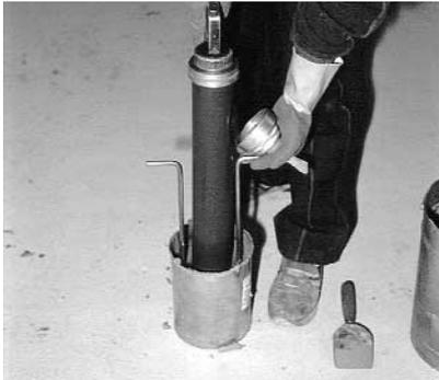
Befüllen der Pistole über Druckplatte.
