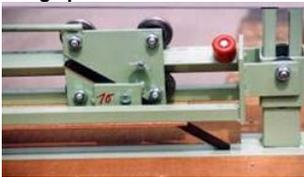
3) Bei Zuschnitten von festen Materialien kann man das Schneidegerät vorne auf die gewünschte Höhe mit einer Flügelschraube fixieren.
