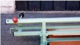
4) Bei Zuschnitten von weichem Material (Klemmfilz usw.) wird das Material beim Zuschneiden gepresst. Dabei löst man vorne nur die Stellschraube und hebt den Schneidearm nach oben. Durch Drehen nach links eines eingebauten Fixierstabes bleibt der Schneidearm ...
