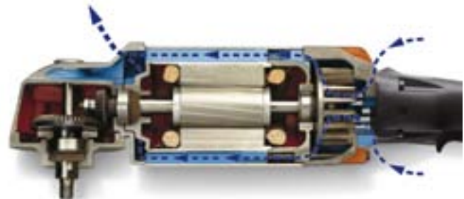
Schnittbild eines gekapselten oberflächengekühlten FEIN Hochfrequenzmotors.
