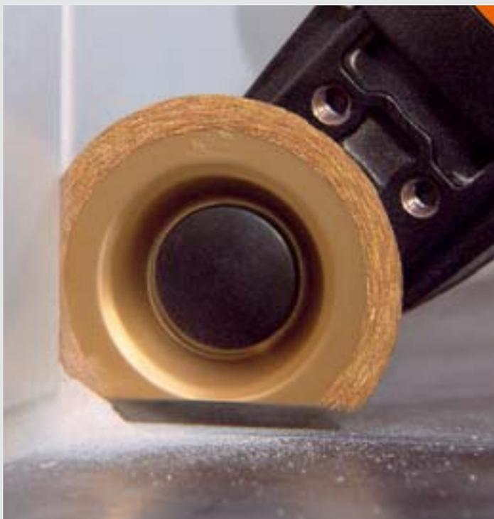
Beim Entfernen schadhafter Fliesenfugen in Ecken und an Kanten kommt das Segmentsägeblatt zum Einsatz, das exaktes Arbeiten ohne Überschneidungen ermöglicht. Das Segmentsägeblatt ist in Hartmetall- oder Diamant-Qualität erhältlich – Letztere überzeugt durch deutlich höhere Standzeiten und eignet sich auch für frostsichere, epoxydharzhaltige Fugenmaterialien im Außenbereich oder für den Fugenaustausch.
