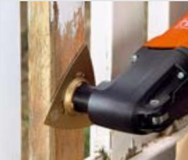
Mit der Hartmetall-Raspel entfernen Sie selbst hartnäckigste Verwitterungsspuren gründlich – und dank hoher Abtragsleistung auch besonders schnell.
