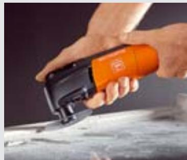
Brüchige Kittfasen lassen sich mit dem HSS-Segmentsägeblatt problemlos und ohne Glasbruchgefahr entfernen.
