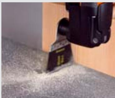
Aussparungen für nachträgliche Installationen und Umbauten zu sägen, ist mit den E-CUT-Sägeblättern auch bei schon montierten Platten kein Problem.
