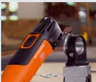
Mit der neuen Tisch- und Bohrständeralterung können Sie Ihren FEIN MULTIMASTER fixieren, um Werkstücke präzise zu bearbeiten.
