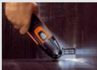
Bei der Restaurierung von Möbeln lassen sich bisher zeitaufwändige Handarbeiten wie Profilschleifen deutlich schneller und effizienter erledigen.
