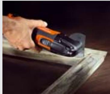
Mit dem HSS-Segmentsägeblatt renovieren Sie alte Fenster perfekt und arbeiten mühelos bis in die Ecke – zeitintensives Nacharbeiten entfällt.
