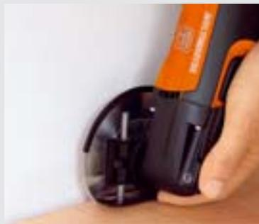
Mit dem HSS-Sägeblatt Holz wird der FEIN MULTIMASTER zu einer „Mini-Kreissäge“ – ideal für lange, präzise Schnitte, z. B. bei Dehnfugen in Parkett und Laminat. Mit oder ohne Tiefenanschlag einsetzbar.
