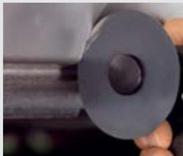
Für Abschnittsreparaturen an unfallbeschädigten Fahrzeugen eignen sich besonders die runden HSS-Segmentsägeblätter. Diese lassen sich mehrfach auf der Antriebswelle verdrehen, was die Standzeit deutlich erhöht.
