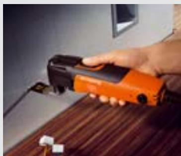
Mit den E-CUT-Sägeblättern lassen sich Gipskartonplatten spielend einfach zuschneiden und bereits montierte Platten mit Ausschnitten für Elektroinstallationen etc. versehen.
