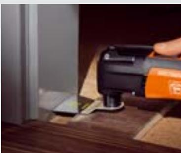
Beim Anpassen von Türstöcken an höhere Bodenbeläge sowie bei Aussparungen in Parkett und Laminat überzeugen die Precision E-CUT-Sägeblätter mit höchster Präzision und Schnittgeschwindigkeit.
